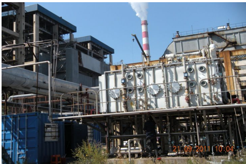
图 2.6.1 低温多效中试装置
