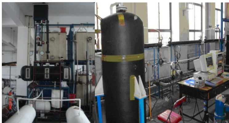
图 2.6.9 水平管降膜蒸发传热实验台
