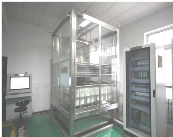
图 2.6.4 低温多效喷淋实验平台
