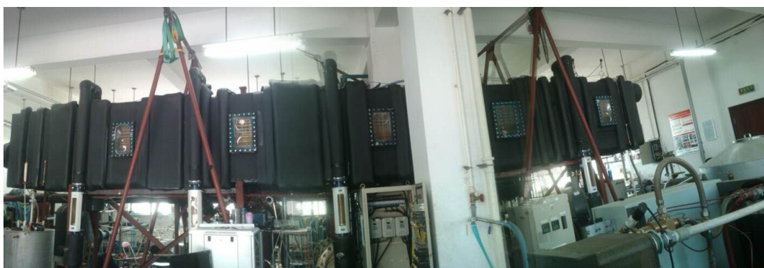
图 2.6.8 水平管降膜蒸发性能测试实验台
