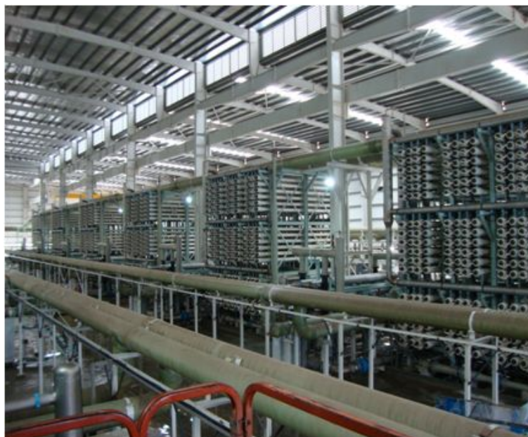
图 1.8.1 新加坡大泉 318,500m 3 /d 海水淡化系统
