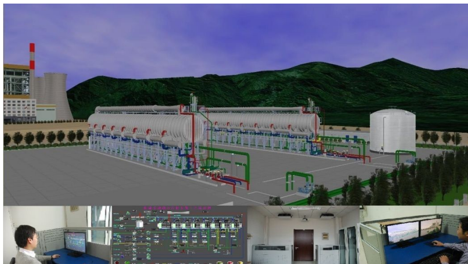
图 2.4.1 低温多效蒸馏海水淡化仿真培训平台
