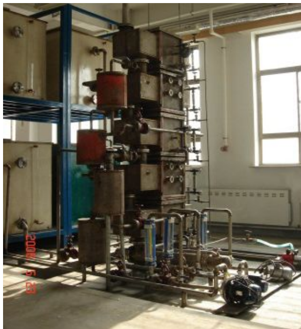
图 2.6.7 五效低温多效系统实验平台
