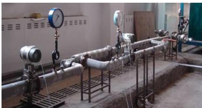
图 2.6.10 喷射器实验台
