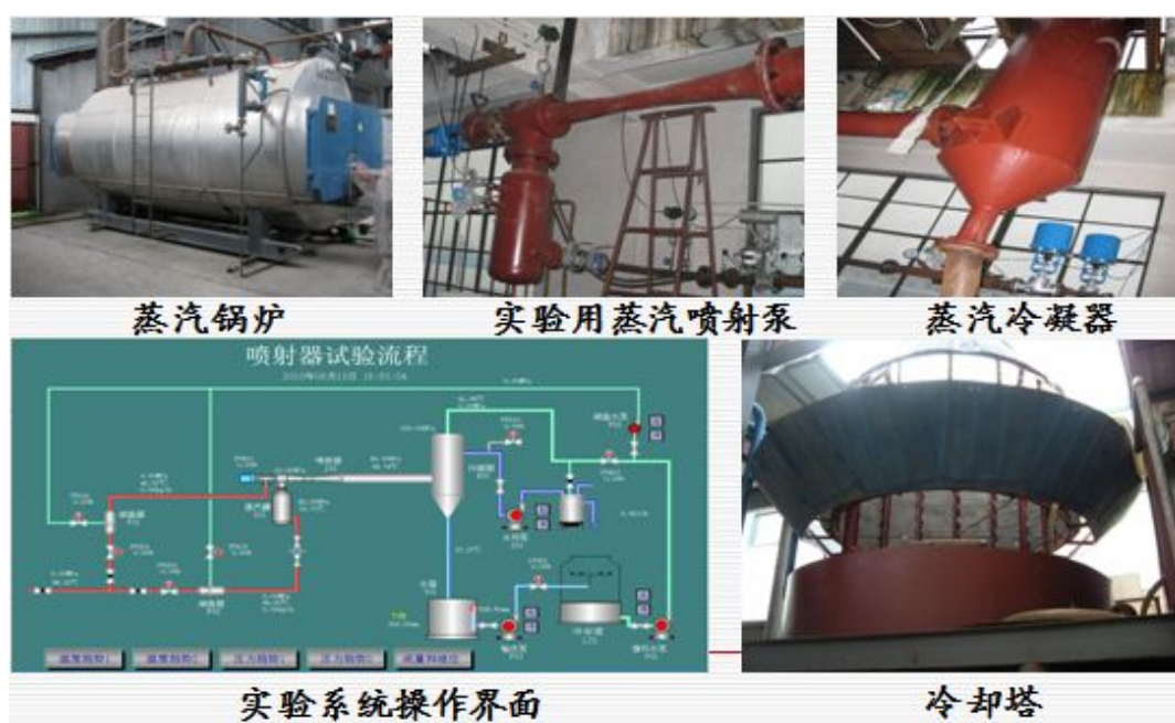
图 2.6.3 蒸汽热压缩实验平台
